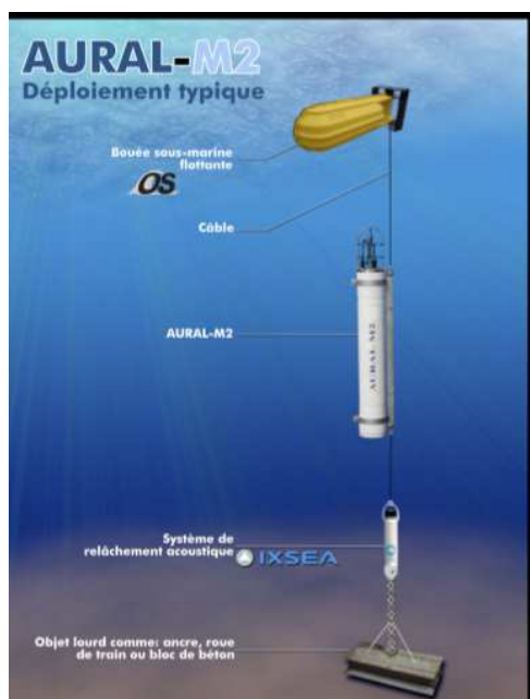
Figure 67: Déploiement de l'hydrophone avec une bouée sous marine flottante
