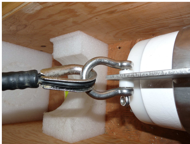
Figure 62: Frottement entre une jonction câble et manille de l'hydrophone
