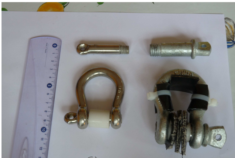
Figure 65: : comparaison entre les deux manilles pour l'installation des hydrophones
